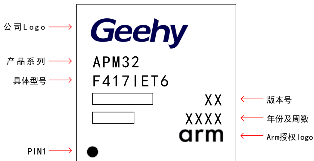
图 18 LQFP176 -176 引脚，24 x24 mm 示意图
