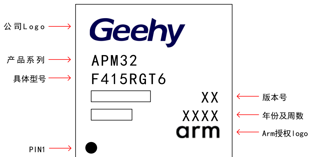
图 27 LQFP64 - 64 引脚，10 x 10mm 示意图
